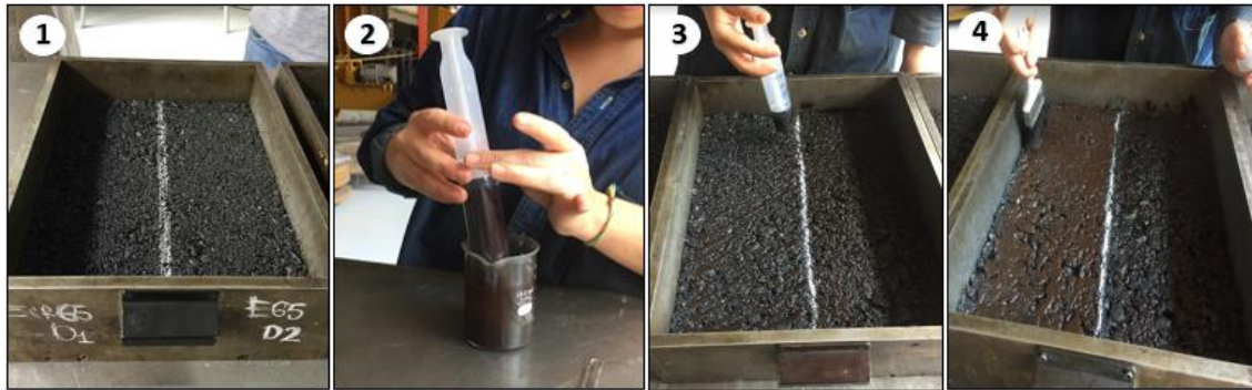
Figura 4. Aplicación de emulsión asfáltica
